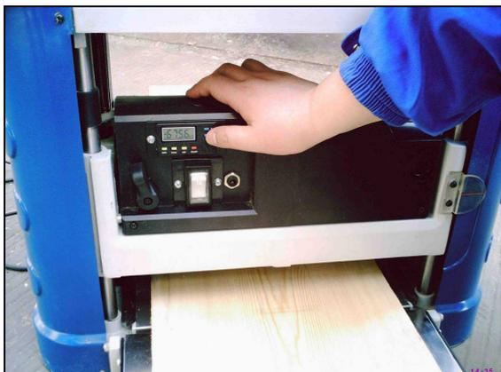
Vous pouvez utiliser la machine après déballage, lecture de la notice et vérification du bon montage des couteaux, guide protecteur, collecteur de copeaux, etc. Insérer et faire glisser la pièce à raboter de préférence au milieu des tables
